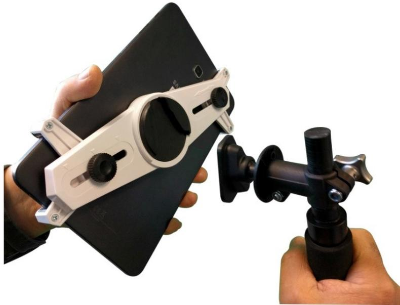
5.2 - Montage Tablet mit Teleskopstange der Universalsonde
